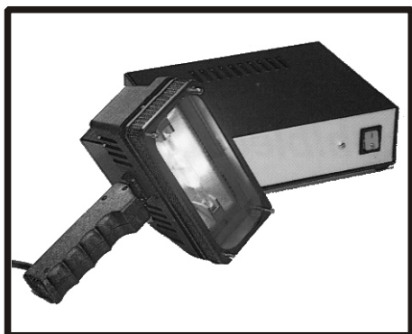
UV - LA 3 Handstrahler UVA-HAND 250 leistungsstarke Handlampe für kurze Aushärtezeiten Abstrahlfläche 7 x 16 cm mit Schwarzglasfilterscheibe
